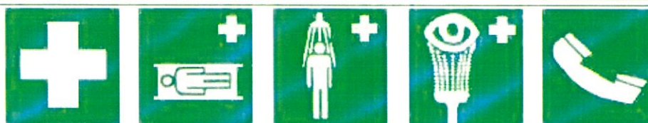
Πρώτες βοήθειες Φορείο Θάλαμος καπνοαερισμού ασφαλείας Πλύση ματιών Τηλέφωνο για διάσωση και πρώτες βοήθειες
