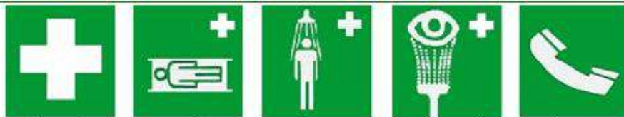
Πρώτες βοήθειες Φορείο Θάλαμος καταιονισμού ασφαλείας Πλύση ματιών Τηλέφωνο για διάσωση και πρώτες βοήθειες
