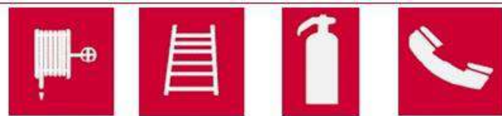
Πυροσβεστική μάνικα Σκάλα Πυροσβεστήρας Τηλέφωνο για την καταπολέμηση πυρκαγιών
